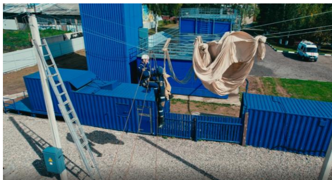
Рисунок 3 – Тренажер для подготовки спасателей к работе на высоте / Figure 3 – Simulator for training rescuers to work at height
