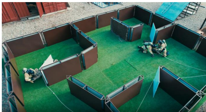
Рисунок 5 – Тренажер для подготовки пожарных к ведению разведки, поиску и спасению пострадавших / Figure 5 – Simulator for preparing firefighters for reconnaissance, search and rescue of victims
