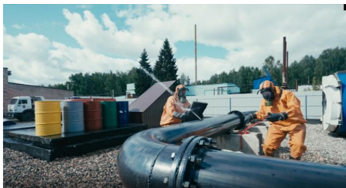
Рисунок 2 – Тренажер для подготовки пожарных и спасателей к ликвидации техногенных аварий, связанных с разгерметизацией технологических трубопроводов и выходом опасных жидкостей наружу / Figure 2 – Simulator for training firefighters and rescuers to eliminate man-made accidents associated with depressurization of technological pipelines and the release of hazardous liquids to the outside
